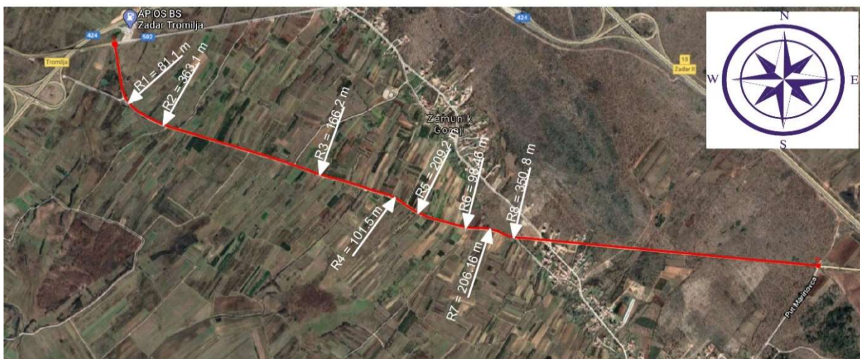
Slika 3. Dionica s pripadajućim radijusima
