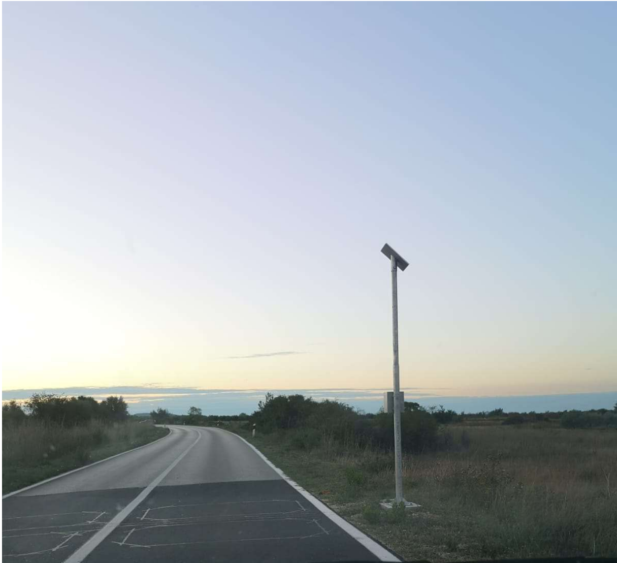
Slika 7. Automatski brojač prometa na lokaciji Tromilja
