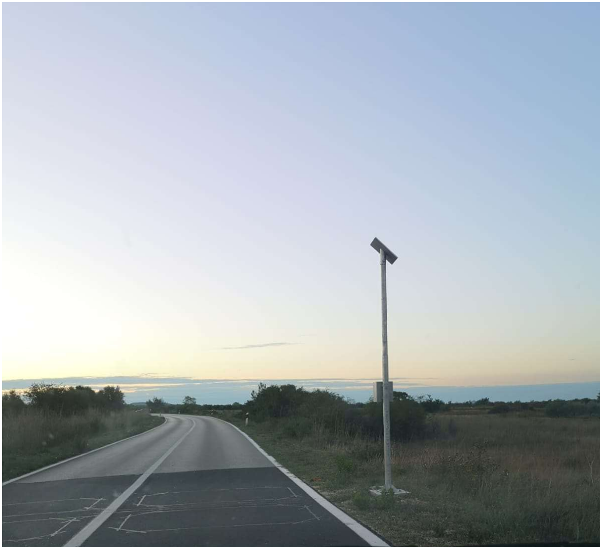
Slika 7. Automatski brojač prometa na lokaciji Tromilja
