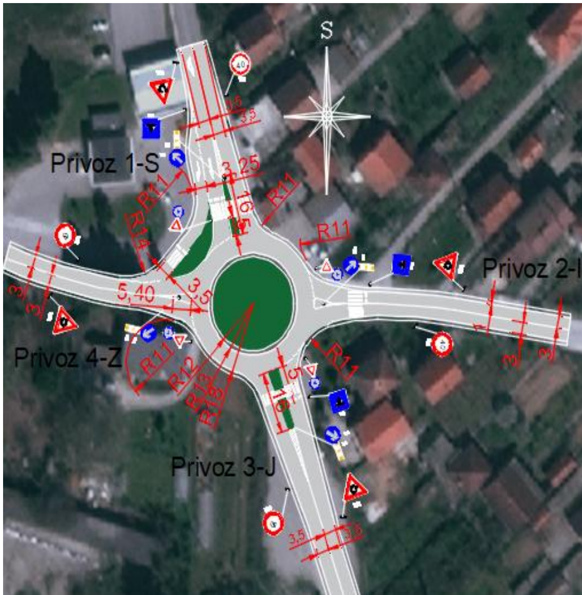
Slika 17. Prijedlog rješenja raskrižja 2.2- raskrižje s kružnim tokom prometa (RKT-raskrižje)
