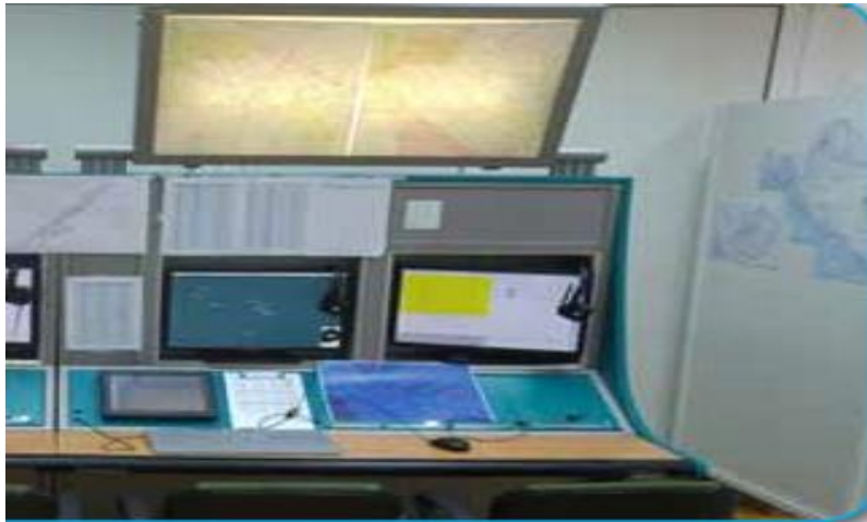
Slika 2. Simulator za radarsku kontrolu zračnog prometa Izvor: [7]
