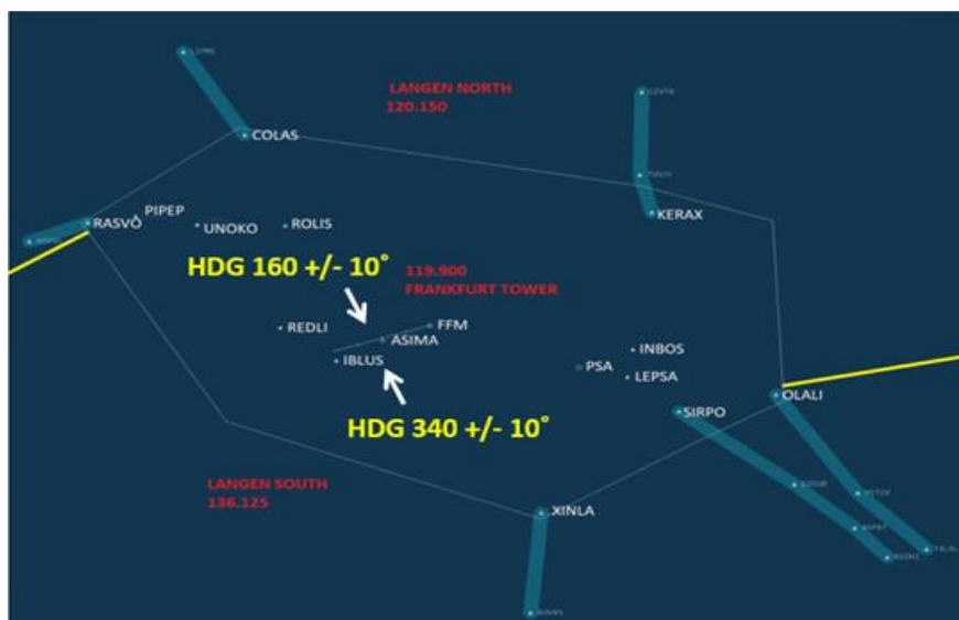
Slika 9. Završni heading za zrakoplove
