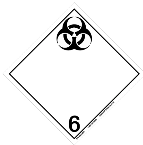
Slika 8. Listica opasnosti za infektivne tvari
