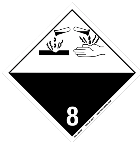
Slika 11. Listica opasnosti za nagrizajuće tvari
