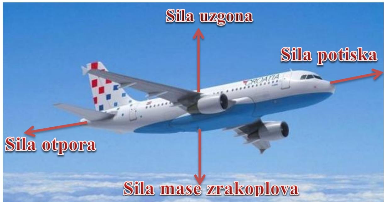
Slika 1. Sile koje djeluju na zrakoplov u letu
