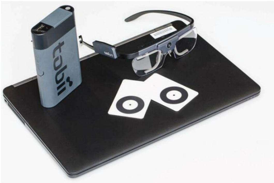
Slika 6. Elementi sustava za praćenje oka (Tobii Pro Glasses 2)
