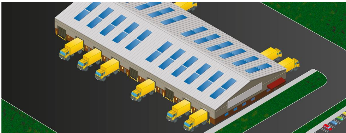
Slika 15. Cross docking terminal sa različitim stranama iskrcaja/ukrcaja
