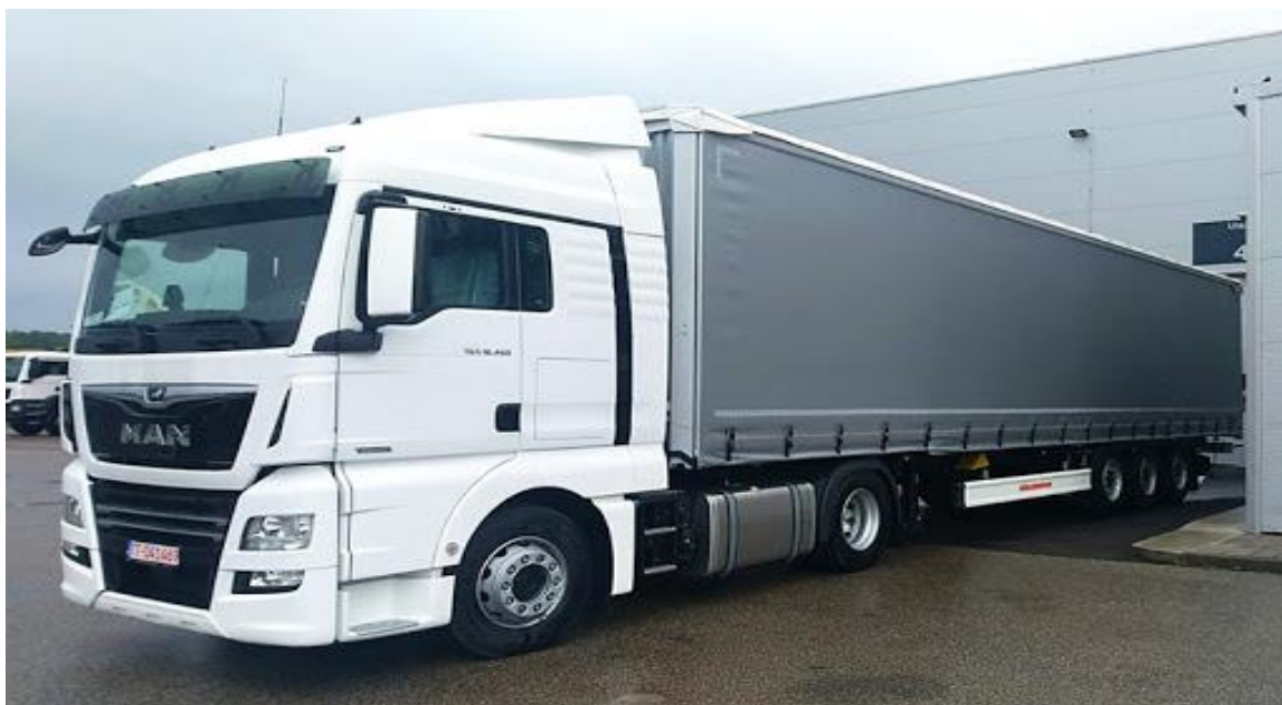
Slika 11: Dvoosovinski tegljač s troosovinskom poluprikolicom
