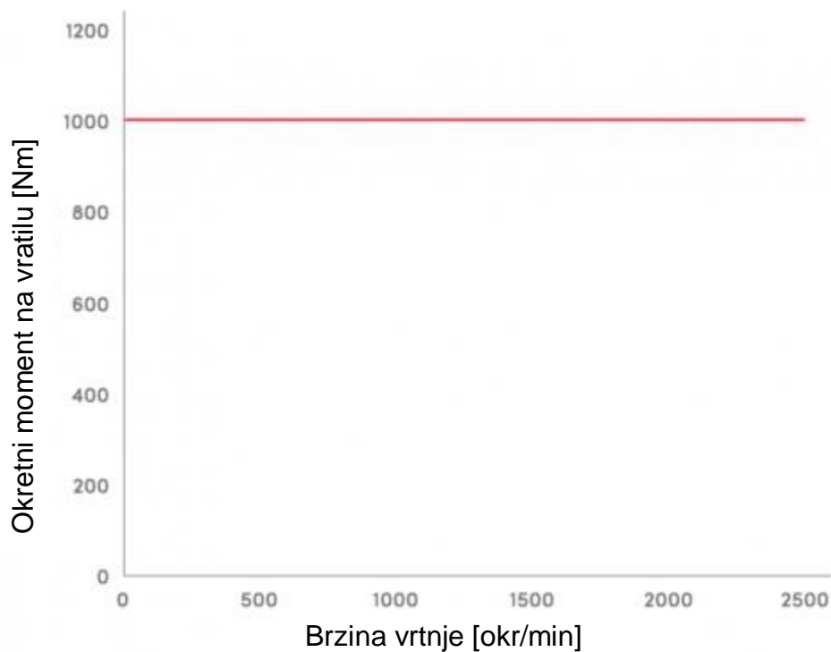
Slika 8. Krivulja (pravac) performansi Magni5 motora [6]
