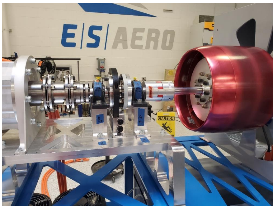
Slika 10. Joby elektromotor na ispitnom stolu [9]
