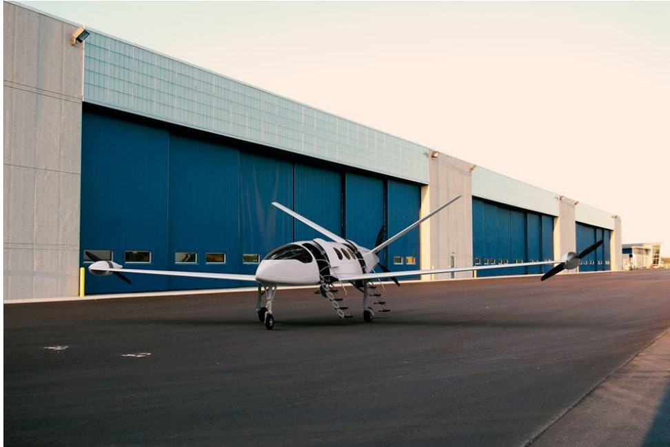
Slika 9. Eviation Alice zrakoplov pogonjen Magni250 motorom [8]
