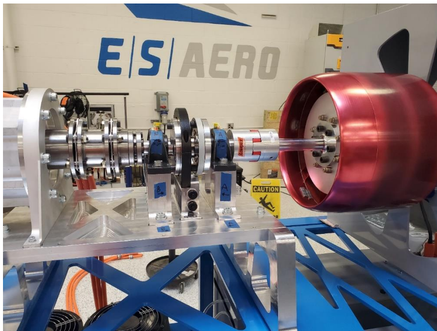
Slika 10. Joby elektromotor na ispitnom stolu [9]
