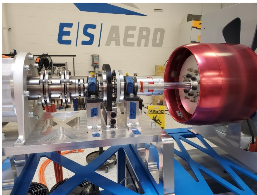
Slika 10. Joby elektromotor na ispitnom stolu [9]
