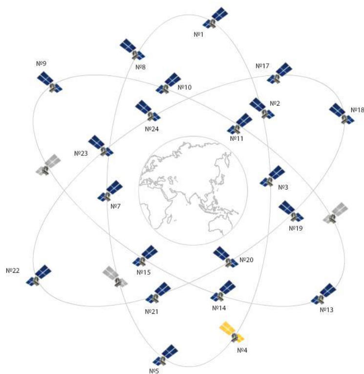
Slika 9. Orbite GLONASS satelita, [6]
