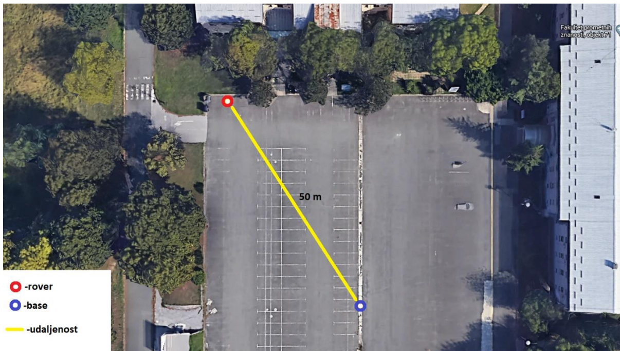
Slika 18. Mjerenje udaljenost stanica 50 m
