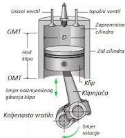
Slika 1. Klip zrakoplovnog klipnog motora s označenim glavnim dijelovima
