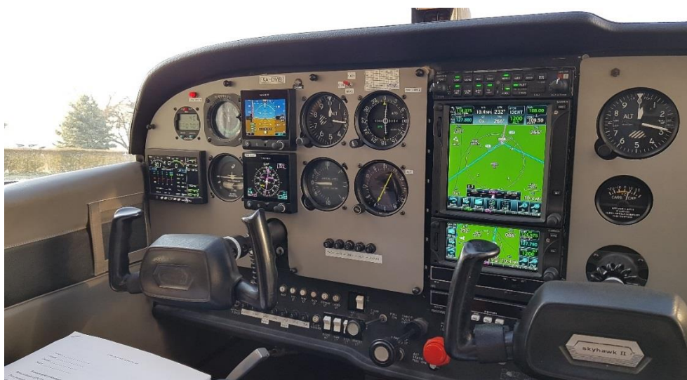
Slika 4. Izgled instrument ploče nakon modifikacije zrakoplova 9A-DMB
