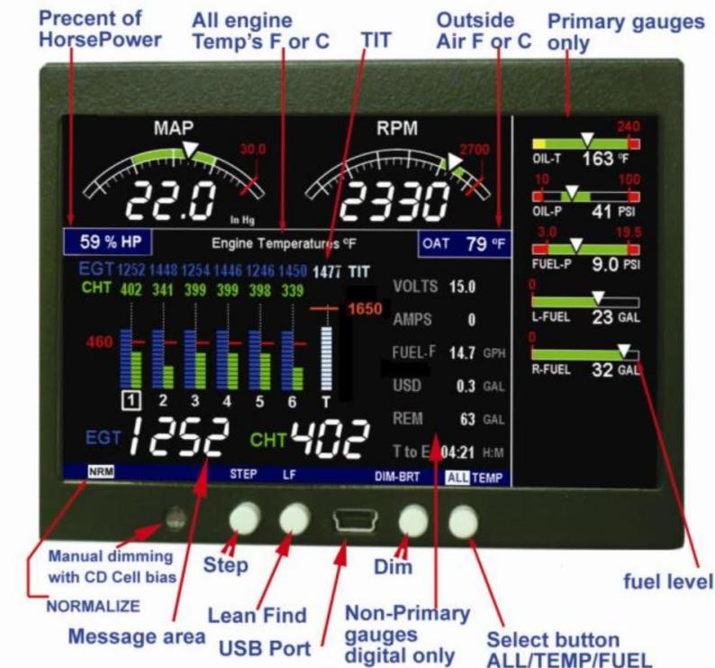
Slika 8. Dijelovi prikaznika
