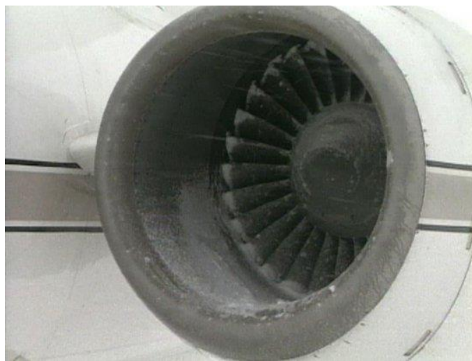
Slika 4. Pojava leda na motoru pri niskim temperaturama [10]
