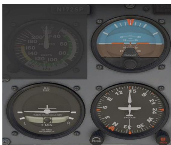
Slika 7 Instrumenti koji se koriste kod zaokreta u instrumentalnom letenju. [2]
