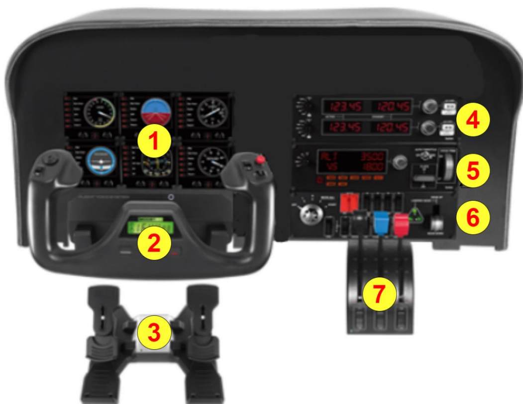
Slika 1 Komponente sintetičkog trenažera leta. [1]
