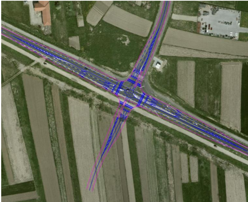
Slika 15: Prijedlog rekonstrukcije raskrižja Južna obilaznica – Travnička
