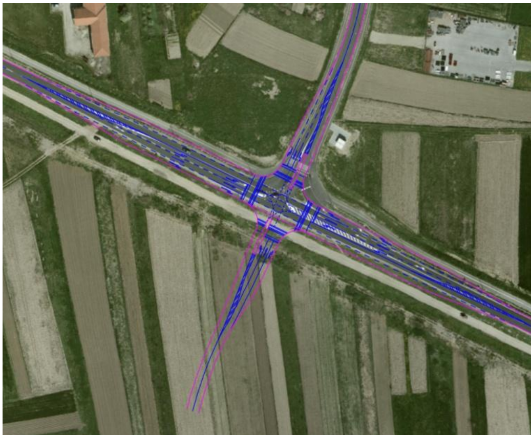
Slika 15: Prijedlog rekonstrukcije raskrižja Južna obilaznica – Travnička
