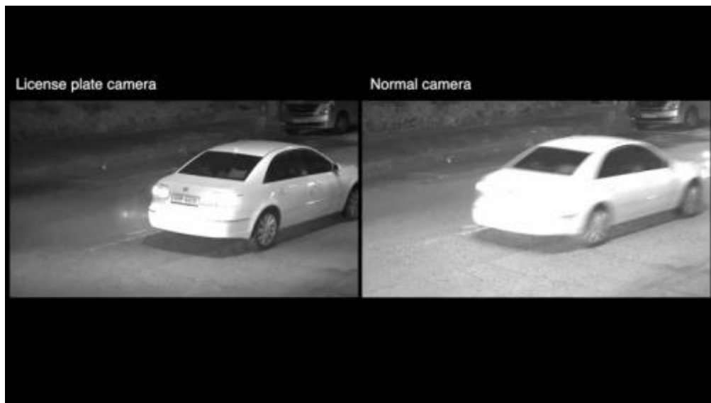
Slika 5. Infracrvena ANPR i obična kamera
