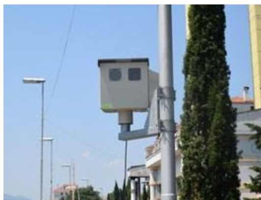
Slika 12. Uređaj za mjerenje brzine i ANPR
