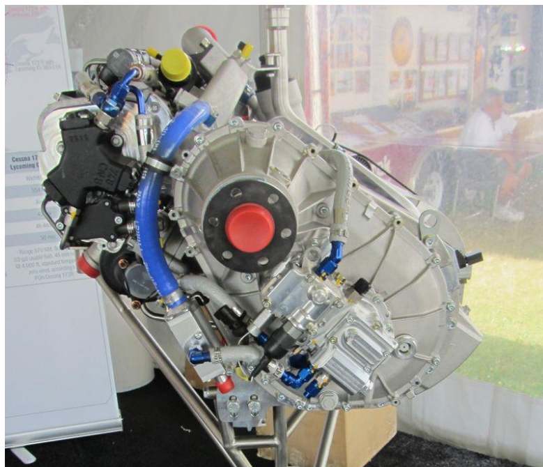
Slika 22. Motor Thielert Centurion 2.0 (TAE 125-02-99), [9]
