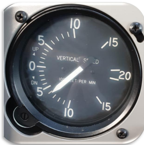
Slika 9. Prikaz indikacije na variometru u spuštanju
