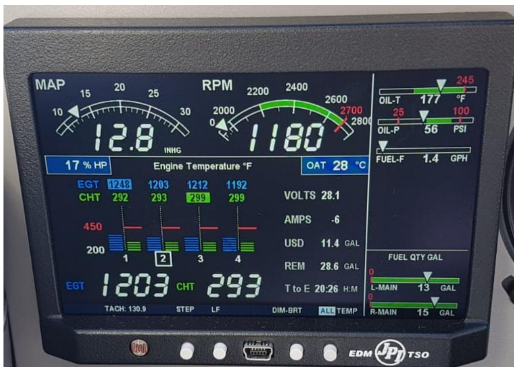
Slika 8. Motorski instrument EDM-900
