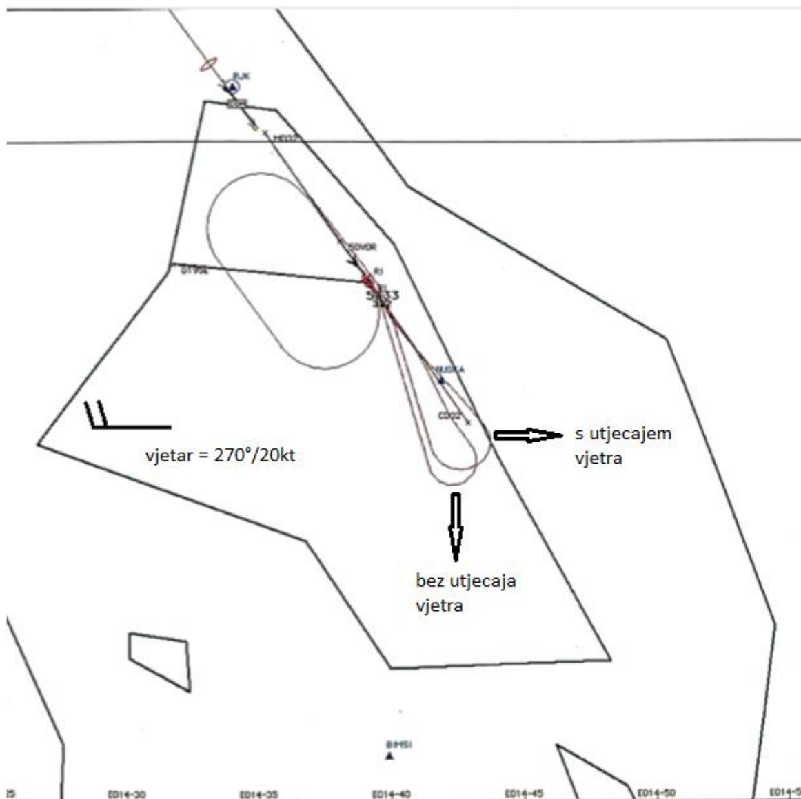
Slika 28. Izgled osnovnog zaokreta u uvjetima bez i s vjetrom odrađenog u trenažeru leta U sljedećem poglavlju, vidljiva je usporedba teorijskog proračuna i izmjerenih elemenata tijekom leta u trenažeru leta te su navedeni brožčani podatci kroz tablice.
