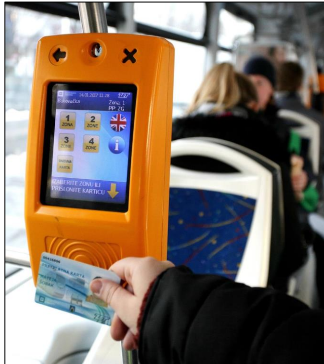
Slika 3. Aparat za poništavanje karata. Izvor: [7]
