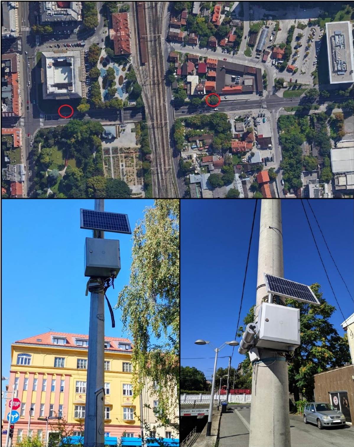
Slika 3. Lokacije i prikaz Bluetooth detektora
