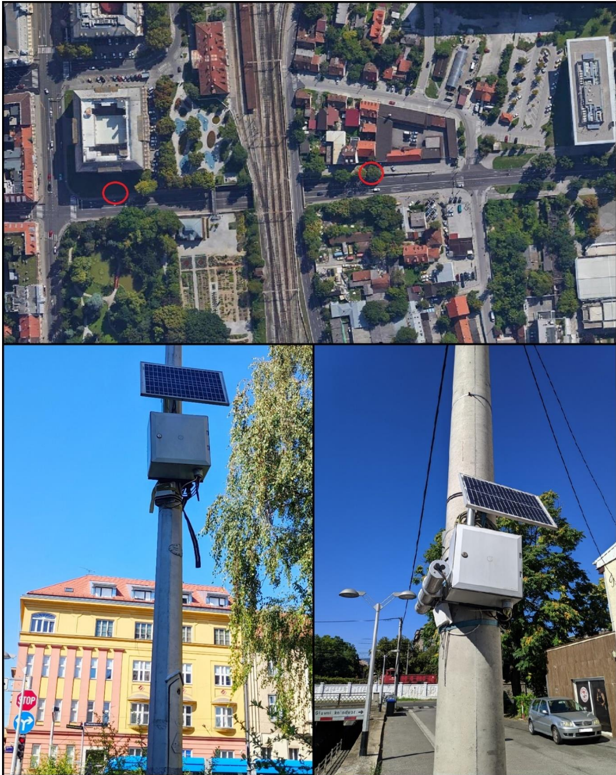
Slika 3. Lokacije i prikaz Bluetooth detektora
