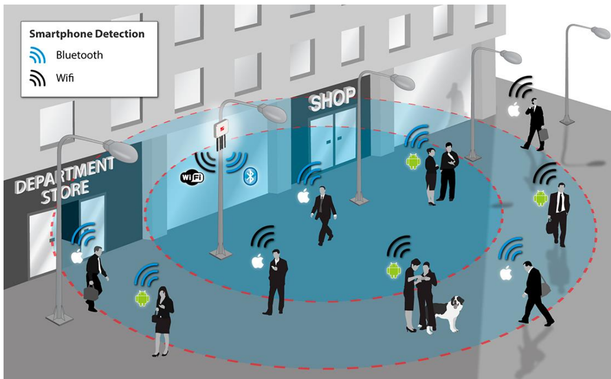
Slika 1. Sustav brojanja pješaka korištenjem BT detektora [20]
