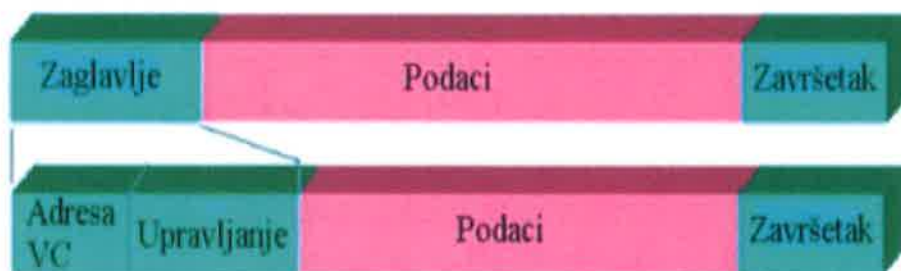
Slika 4. Struktura paketa virtualnog kanala
