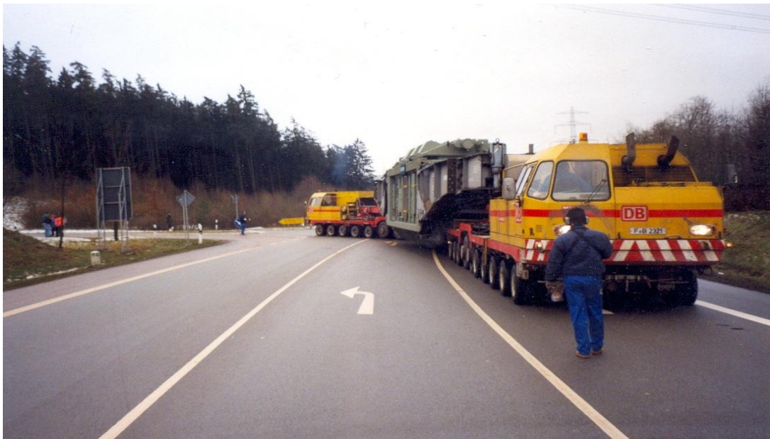
Slika 19. Transformator prekrcan na cestovno vozilo spremno za daljnji prijevoz Izvor: [11]
