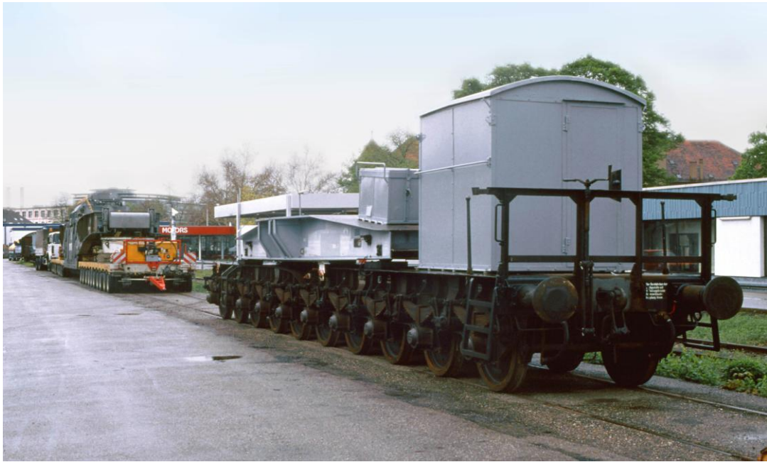
Slika 18. Vagon u krajnjem kolodvoru u kojem je obavljen prekrcaj na cestovno vozilo Izvor: [11]
