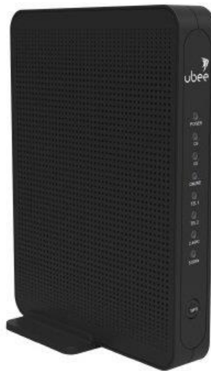
Slika 10. Kabelski usmjernik Ubee EVW32C, [32]
