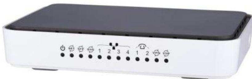
**Slika 19. Optički pasivni terminal Eltek R3621-W1, [43]**
