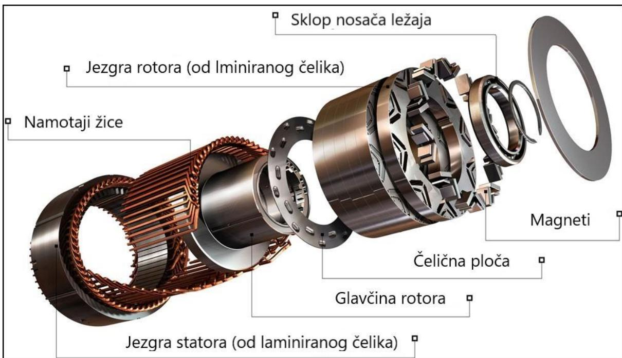
Slika 6. Sinkroni elektromotor sa stalnim magnetima, [15]
