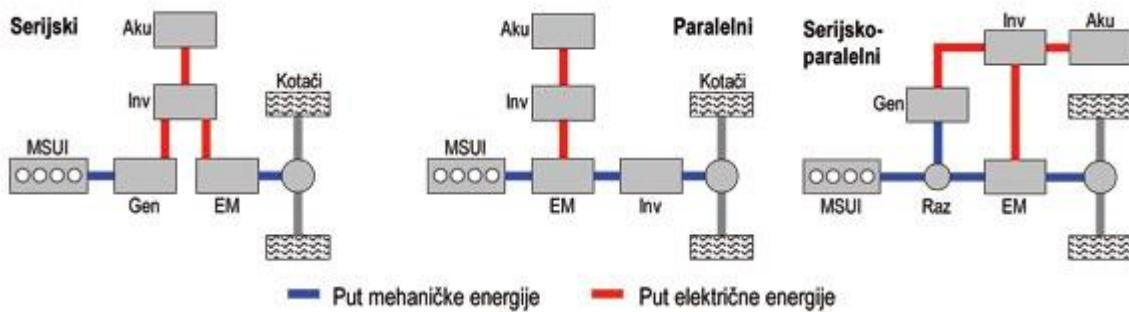
Slika 2. Prikaz pogonskih sustava hibridnih električnih vozila [4]
