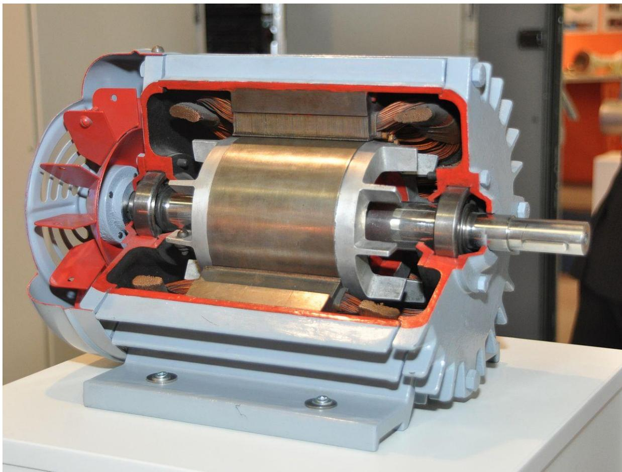
Slika 5. Indukcijski elektromotor, [14]
