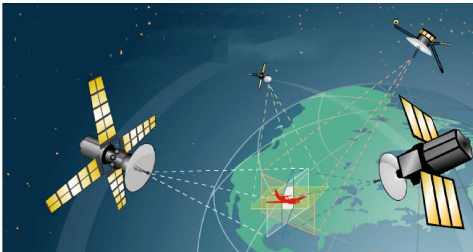
Slika 4.3. Grafički prikaz određivanja pozicije s četiri satelita
