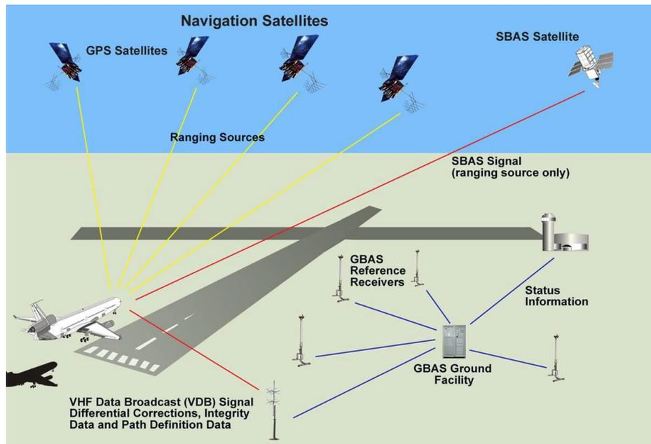
**Slika 4.5.** Način funkcioniranja i dijelovi GBAS sustava, [20].
