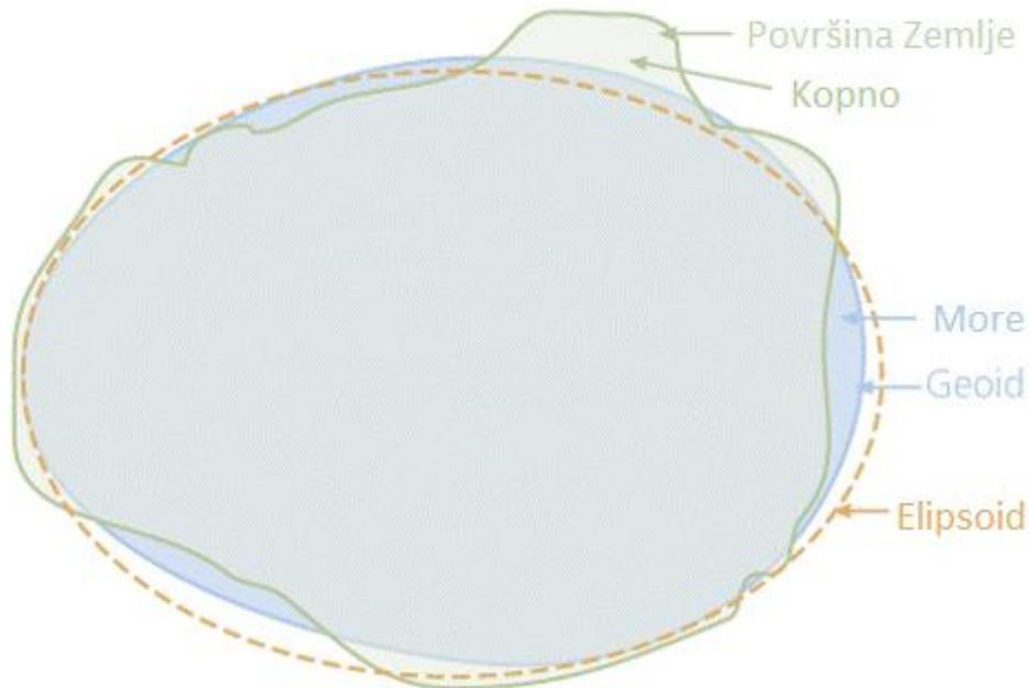
**Slika 4.1.** Izgled elipsoida i geoida u odnosu na površinu Zemlje
