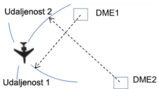
**Slika 3.5.** Preletišće dobiveno sjecištem dvije DME udaljenosti
