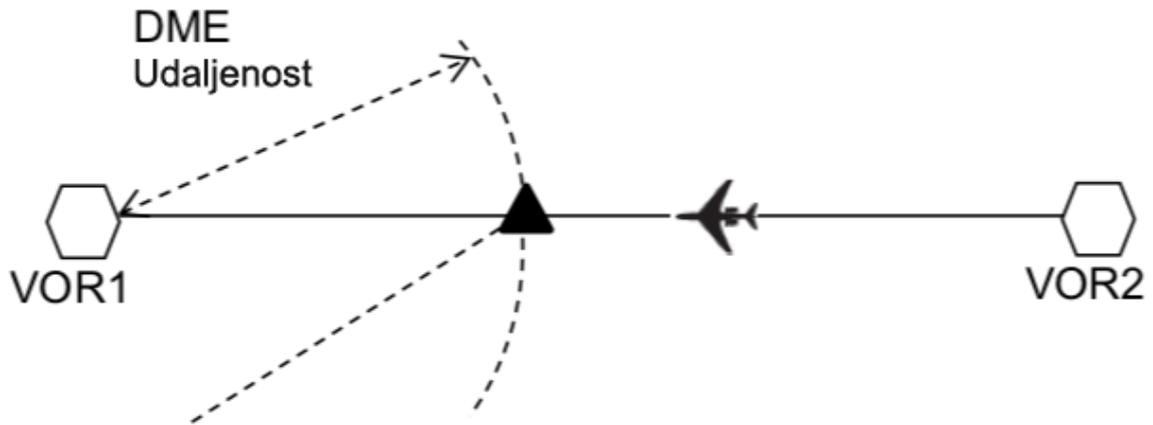
**Slika 3.3.** Preletišće dobiveno sjecištem VOR radijala i DME udaljenosti
