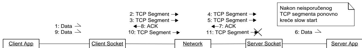
Slika 13.:Dijagram suradnje za algoritme za izbjegavanje zagušenja
