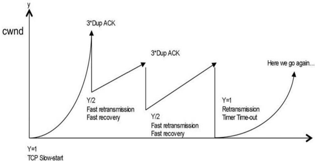
Slika 6.: Prikaz funkcioniranja *slow-start* mehanizma<sup>25</sup>
