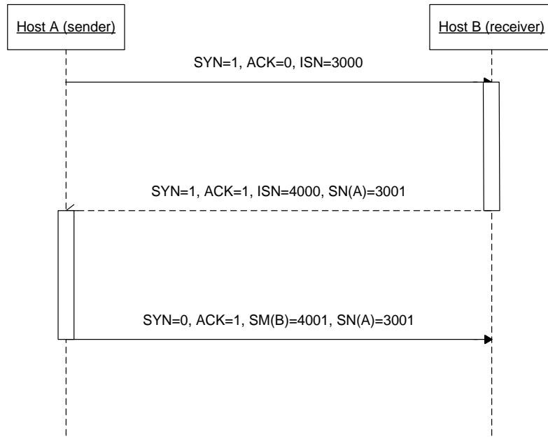
Slika 2. Proces uspostavljanja veze korištenjem *3-way handshake* mehanizma
