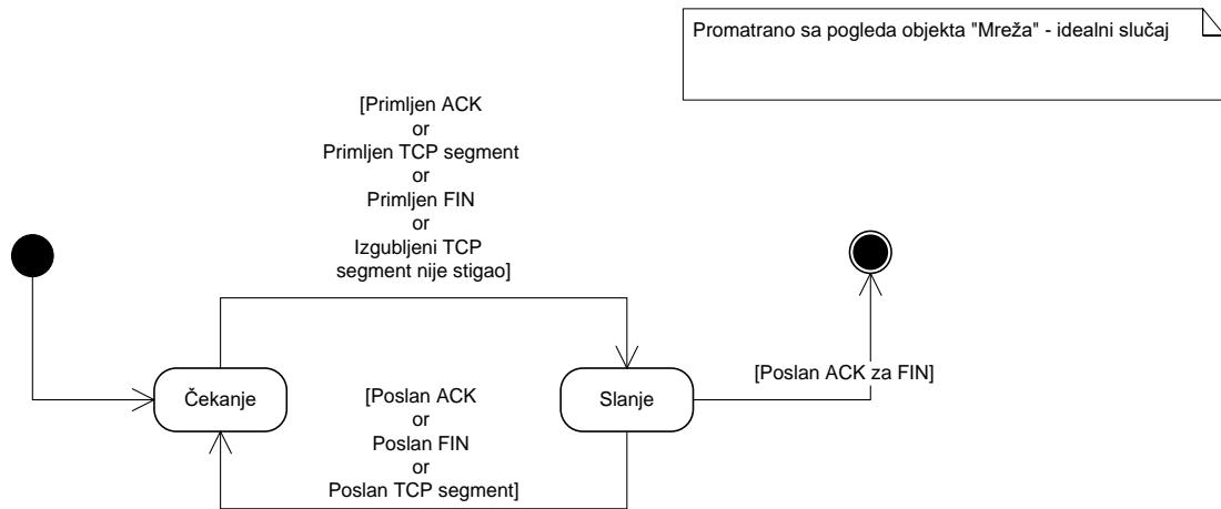
Slika 18.:Dijagram stanja i prijelaza za mehanizam brze retransmisije
