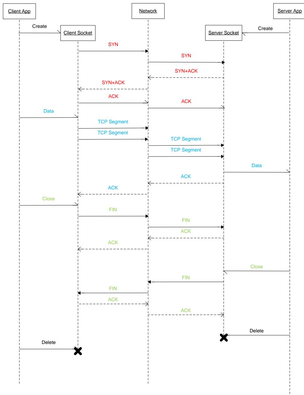
Slika 3.: Dijagram međudjelovanja za *3-way handshake* mehanizam
