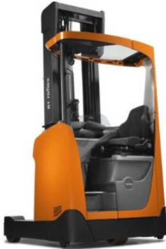
Slika 25: Izgled visokoregalnog viličara, [41]
