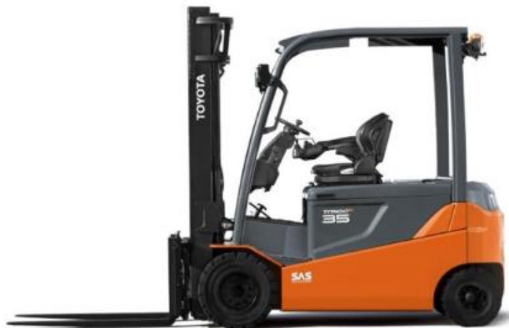
Slika 24: Dvopaletni električni viličar, [41]
