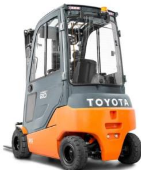
Slika 26: Jednopaletni električni viličar,[41]
