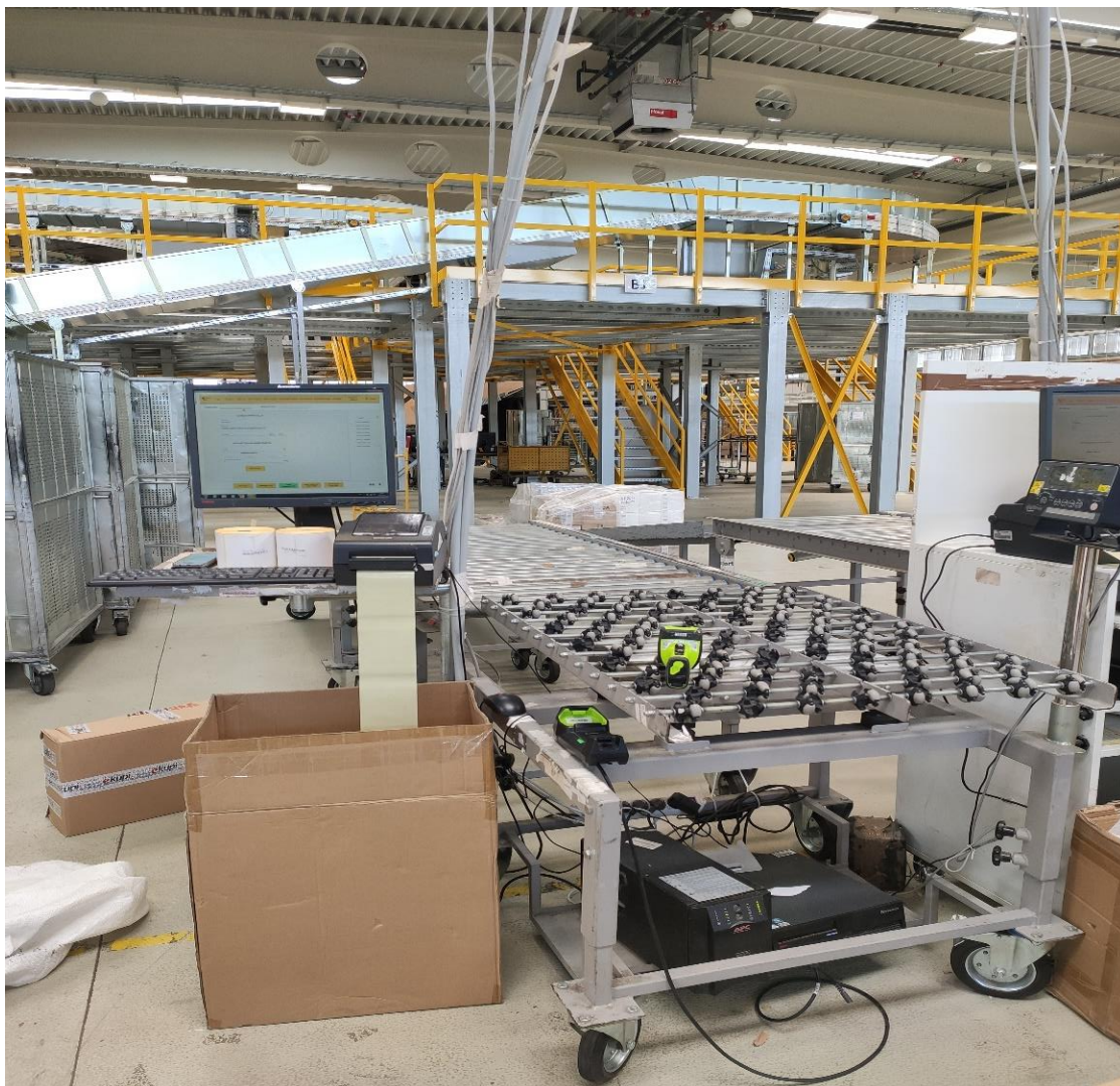
Slika 17: Pozicija za vaganje i skeniranje paketa
