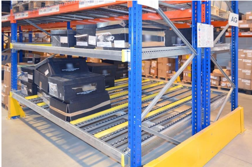
Slika 6: Gravitacijski protočni polični regali
