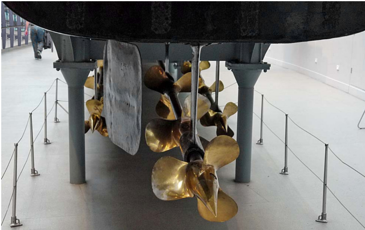
Slika 4. Brodski vijci na brodu „Turbinia“
