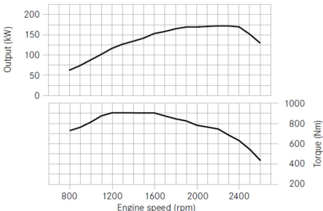
**Slika 19. Krivulje snage (Output) i okretnog momenta (Torque) za model Atego [22]**
