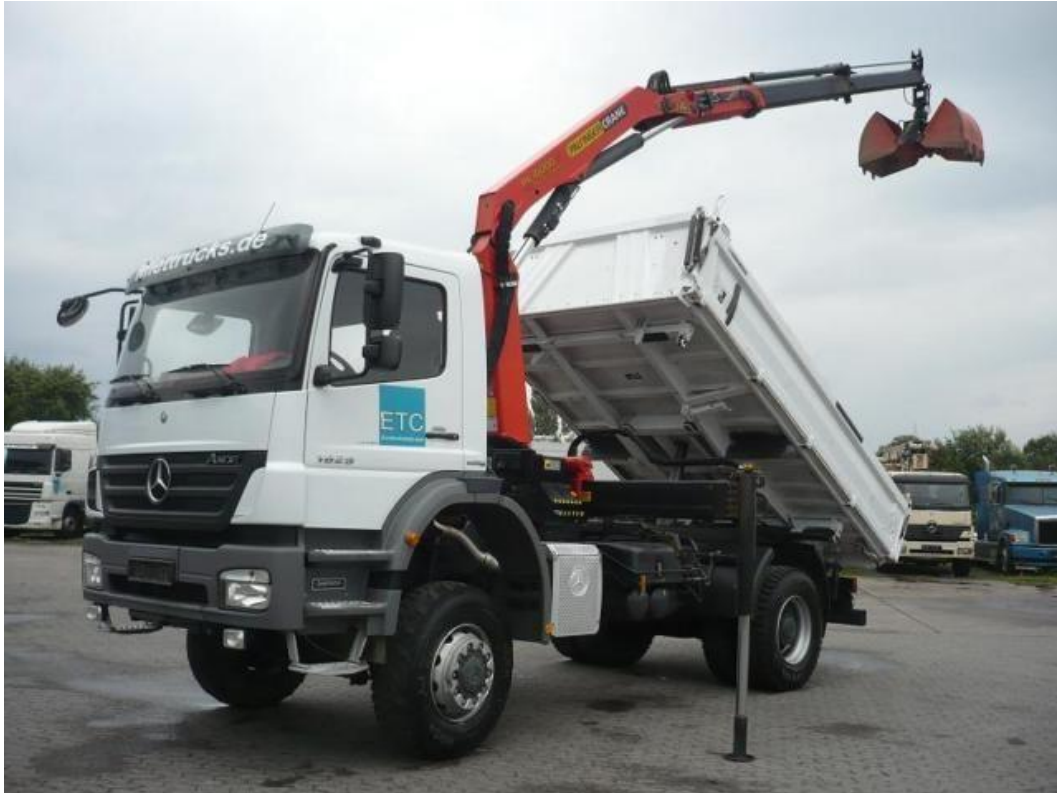
Slika 3. Kamion s kranom [6]
