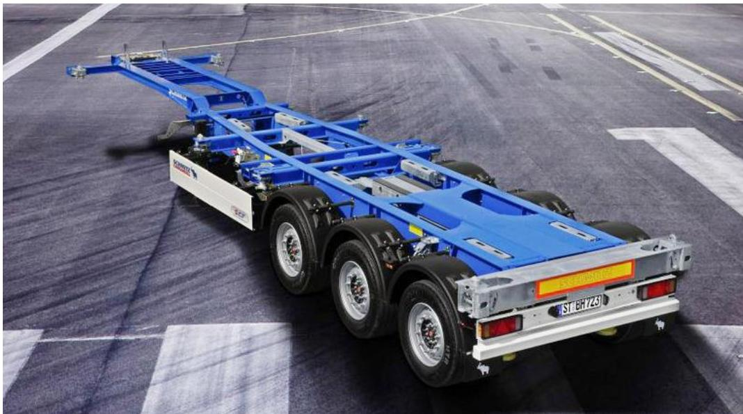
Slika 11. Poluprikolica za prijevoz kontejnera s tri osovine [14]
