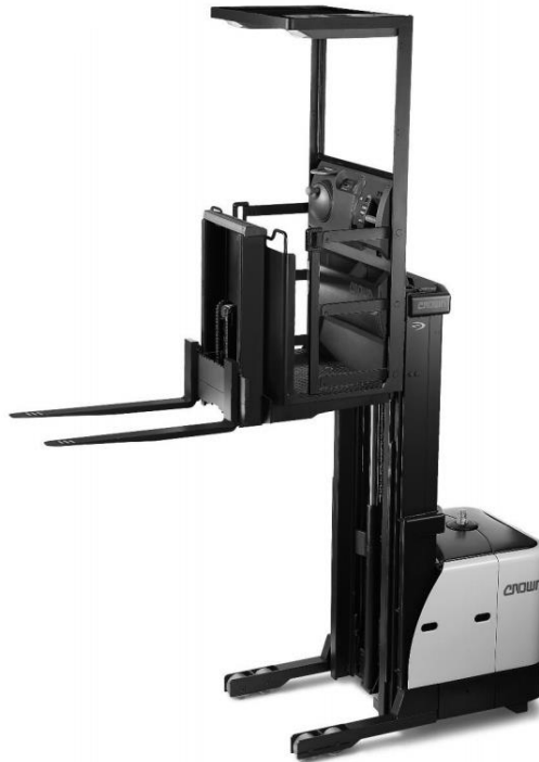
Slika 22. Komisionerski regalni viličar model SP3500 proizvođača Crown [23]
