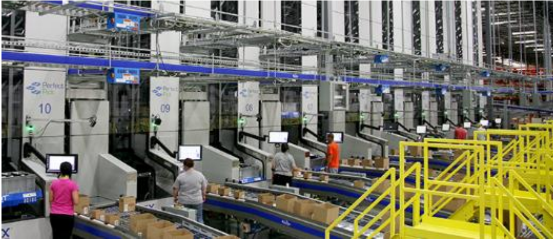
Slika 7. Skladišna mehanizacija za komisioniranje roba-čovjeku [11]
