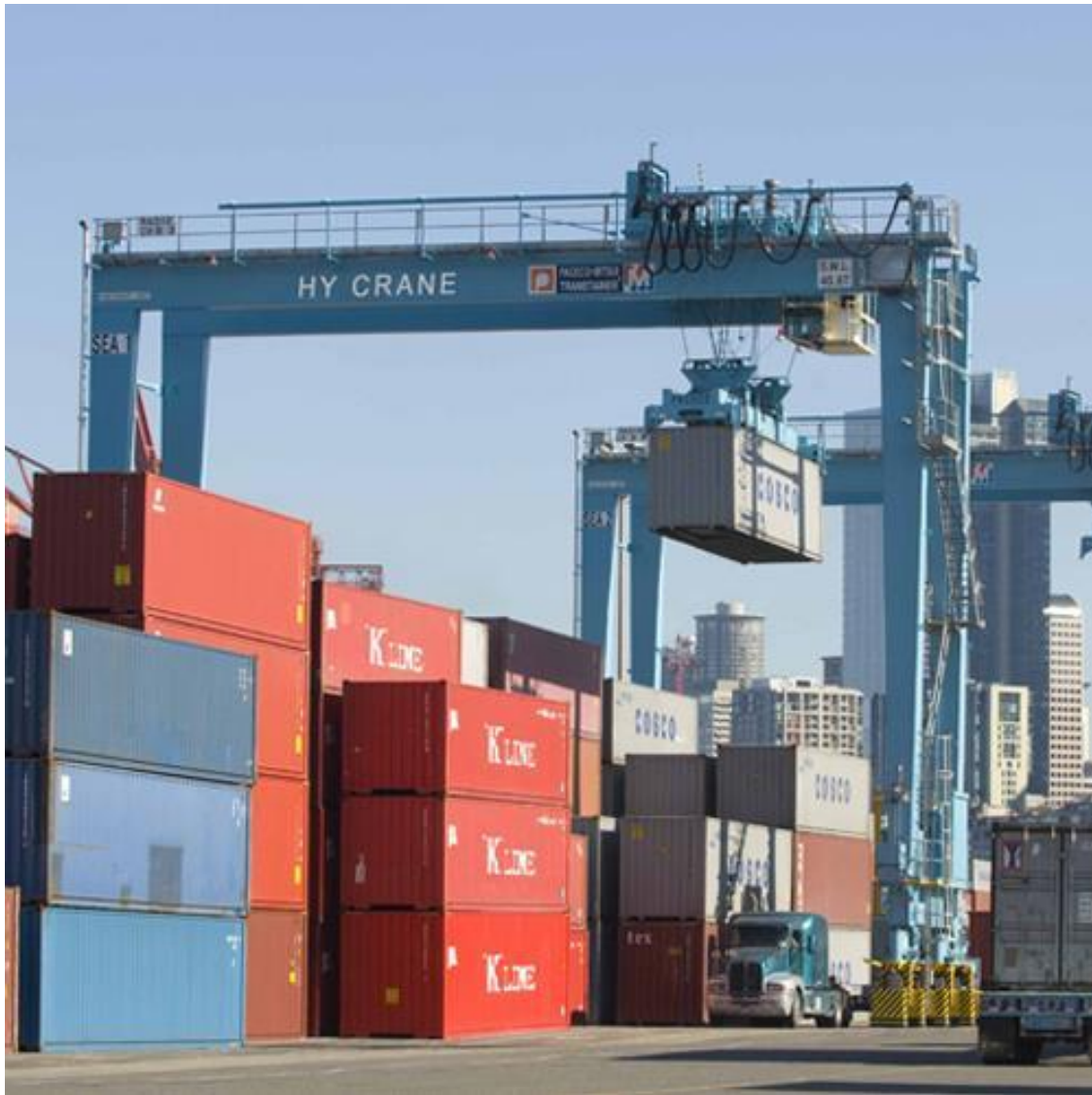
Slika 5. Iskrcaj kontejnera s kamiona Lift on/Lift off sustavom
