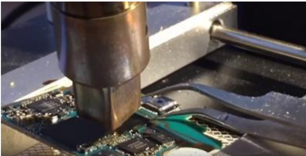
Slika 5. Odvajanje memorijskog čipa, [22].
