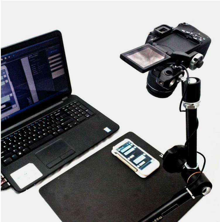
Slika 2. EDEC Eclipse alat za provođenje ručne ekstrakcije, [6]
