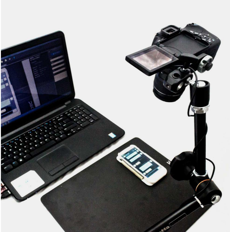
Slika 2. EDEC Eclipse alat za provođenje ručne ekstrakcije, [6]
