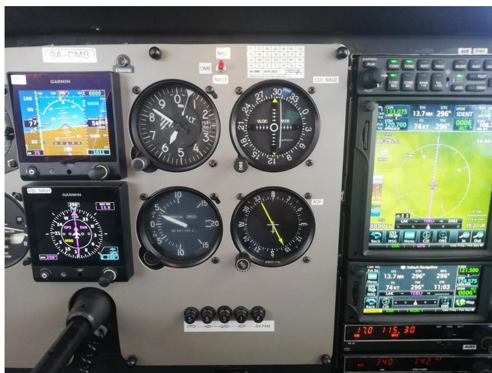
Slika 16. Postavke instrumenata na zrakoplovu 9A-DMB za mjerenje točnosti sustava VOR pri odletu od VOR LAK
