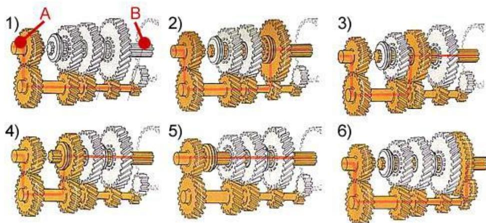
Slika 13. Uključivanje zupčanika ovisno o određenom stupnju prijenosa.[10]
