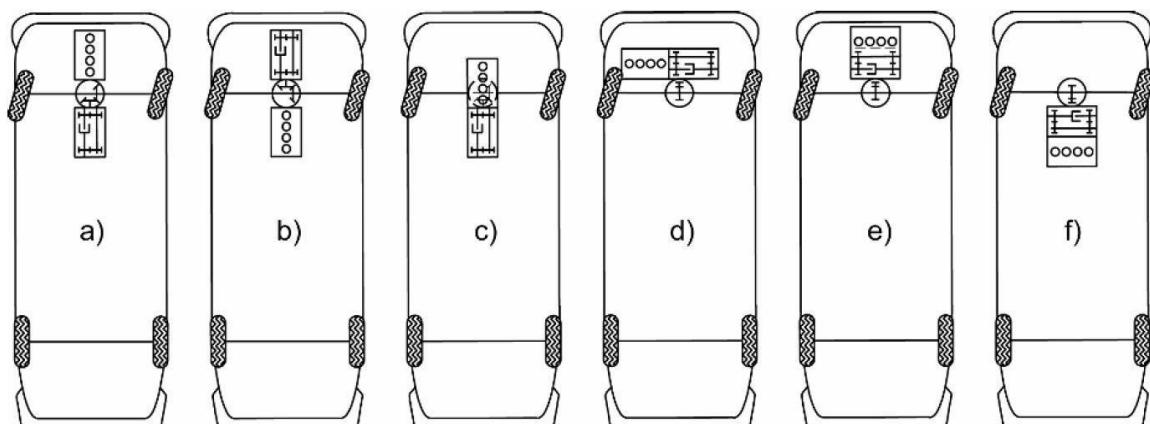
Slika 2. Konfiguracija pogona na prednje kotače [3]
