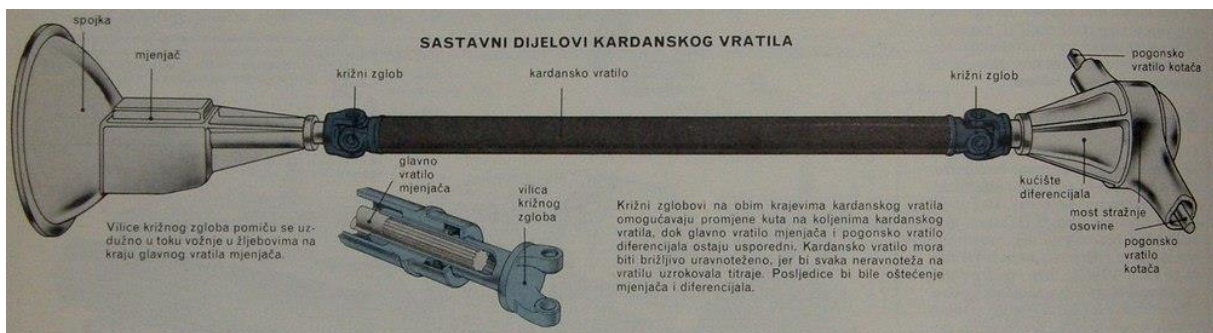
Slika 16. Kardansko vratilo.[10]
