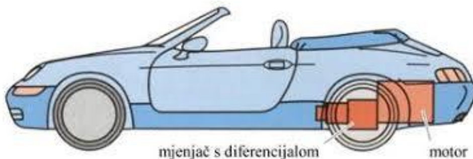
Slika 3. Stražnji pogon vozila sa motorom smještenim na stražnjem dijelu.[7]
