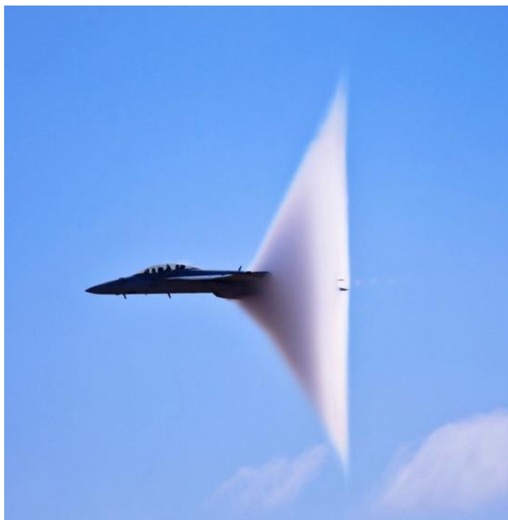
Slika 13. Pojava bijelog oblaka prilikom probijanja zvučnog zida
