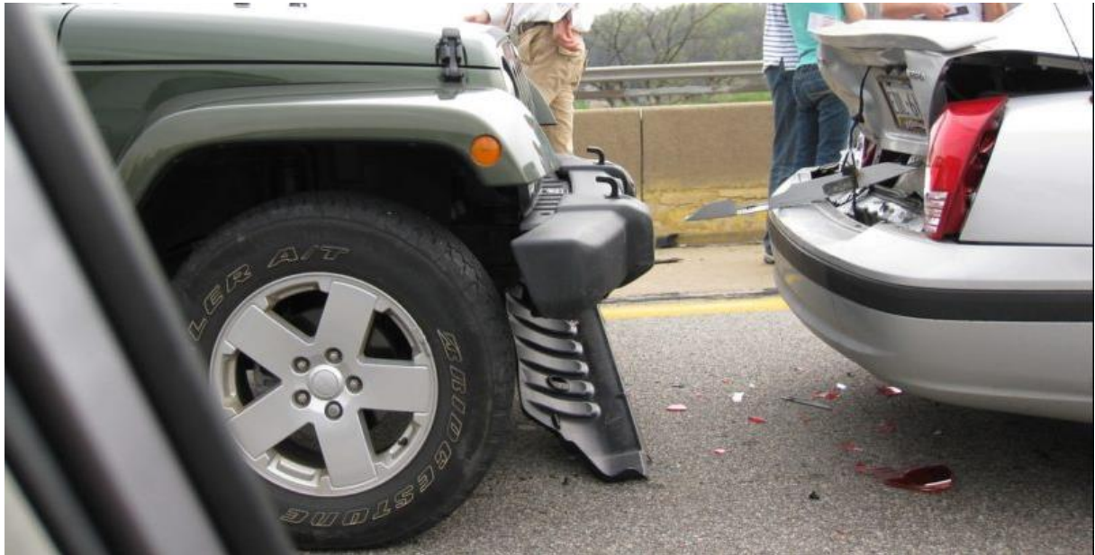
Slika 12. Prikaz visine oštećenja i način na koji je šteta nastala, [28].
